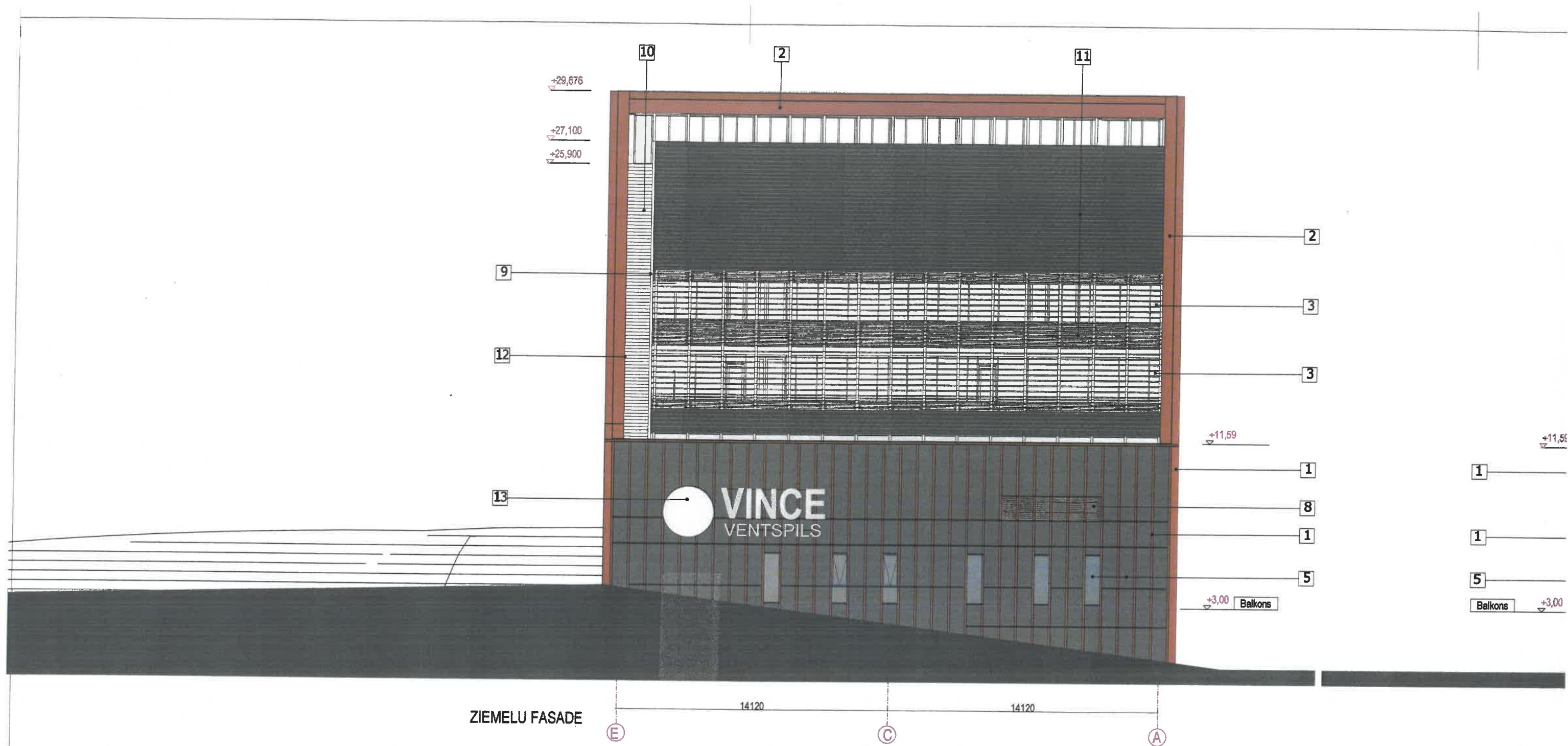
**1** Pilastri 100x400 mm (virsma - Kopmpozīts panelis ar vara plāksnes pārklājumu TECU® Classic Coated Copper Bond
