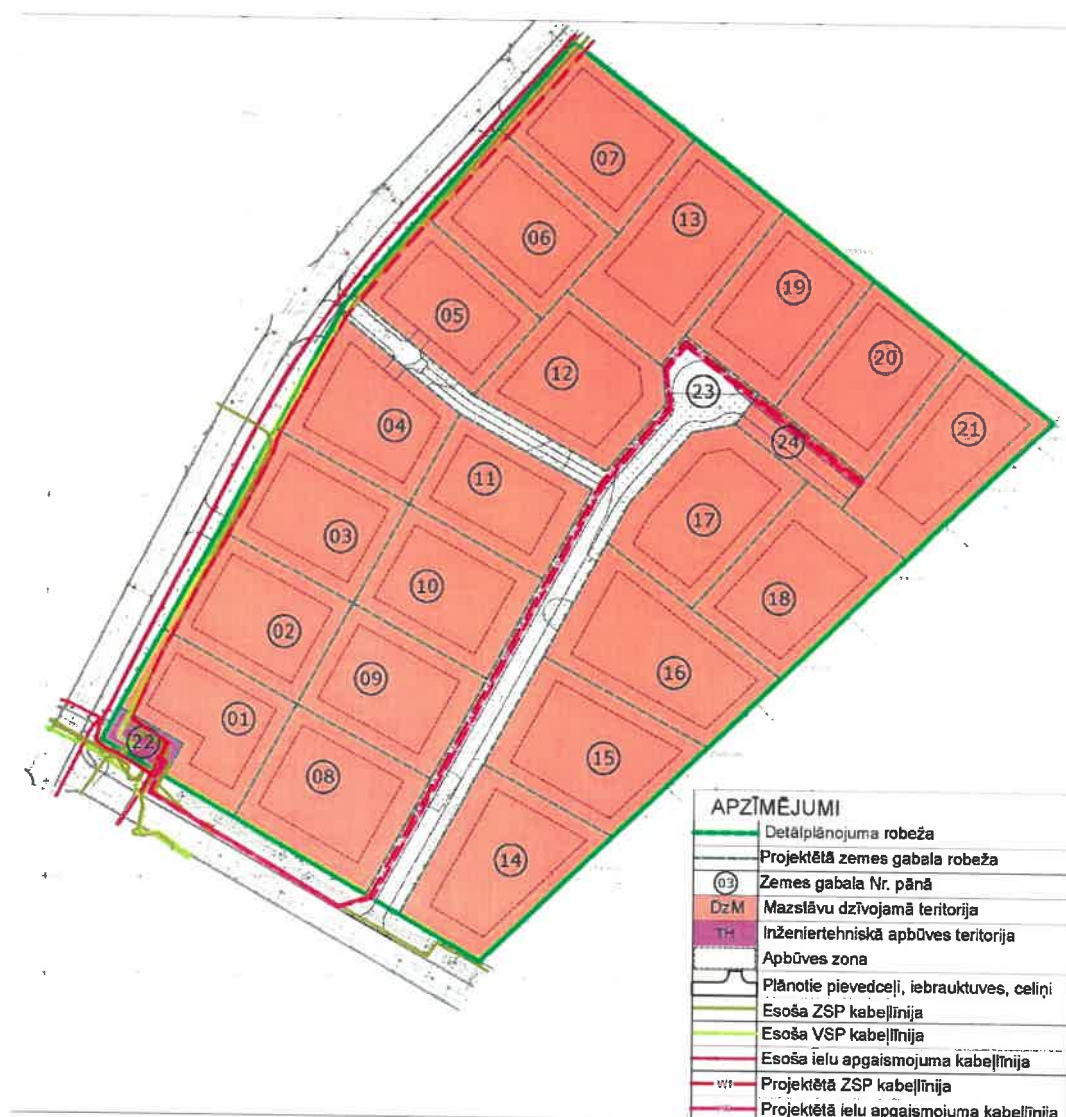
27. att. Detālplānojuma teritorijas elektroapgādes principiālā shēma
