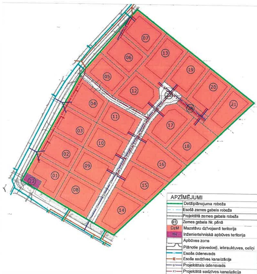
25. att. Ūdensvada un sadzīves kanalizācijas risinājums
