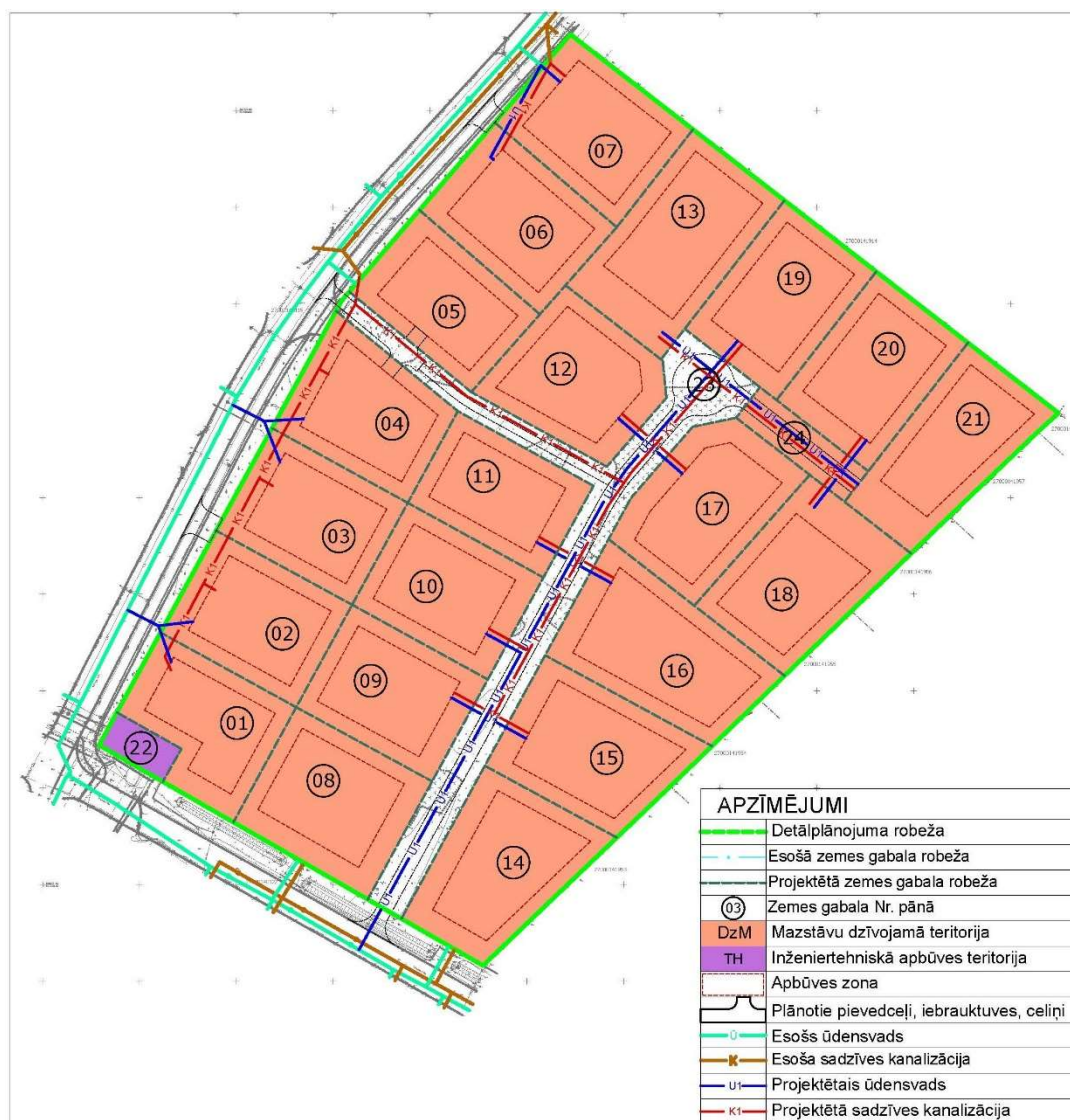
25. att. Ūdensvada un sadzīves kanalizācijas risinājums
